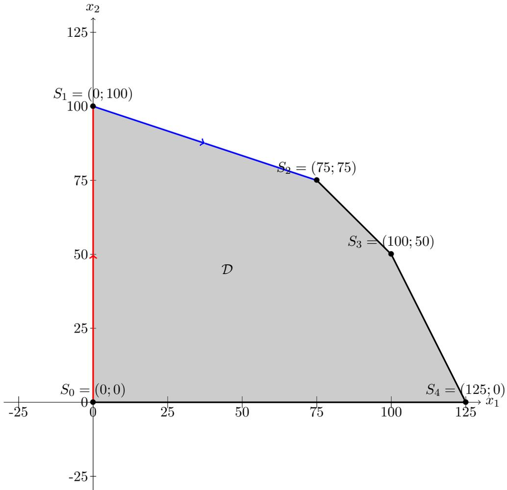
FIGURE 1.3 – Pour résoudre le problème d’optimisation linéaire de l’Exemple 1.9, l’algorithme du simplexe démarre du sommet  $S_0$ . Lors de la première itération (rouge), il décide d’explorer le sommet  $S_1$  puis, lors de la deuxième itération (bleu), le sommet  $S_2$ . L’algorithme s’arrête ensuite puisqu’il est arrivé sur le sommet réalisant le maximum de la fonction objectif sur le domaine  $\mathcal{D}$ . Les sommets  $S_2$ ,  $S_3$  et  $S_4$  ne sont pas visités par l’algorithme.
