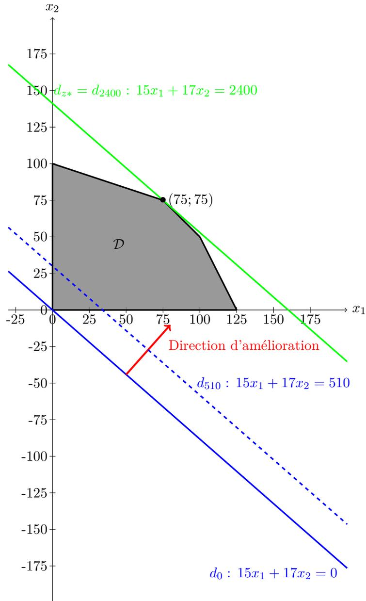
FIGURE 1.2 – Illustration de la résolution du problème d'optimisation linéaire de l'Exemple 1.9 par la méthode graphique.
