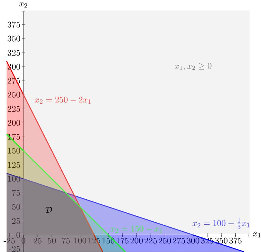
FIGURE 1.1 – Domaine  $\mathcal{D}$  (gris) du problème d'optimisation linéaire de l'Exemple 1.9 défini par les contraintes  $x_1 + 3x_2 \leq 300$  (bleu),  $4x_1 + 2x_2 \leq 500$  (rouge),  $x_1 + x_2 \leq 150$  (vert) et  $x_1, x_2 \geq 0$  (gris clair).
